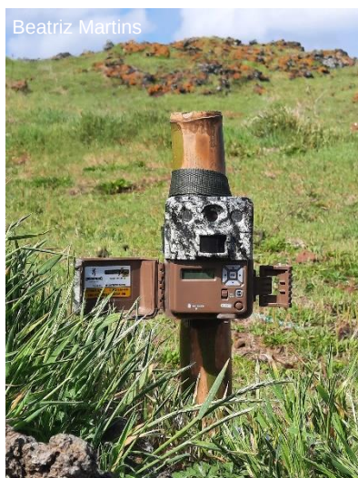
Figura 1. Câmara de vídeo trapping com sensor de movimento colocada no Ilhéu da Praia.
