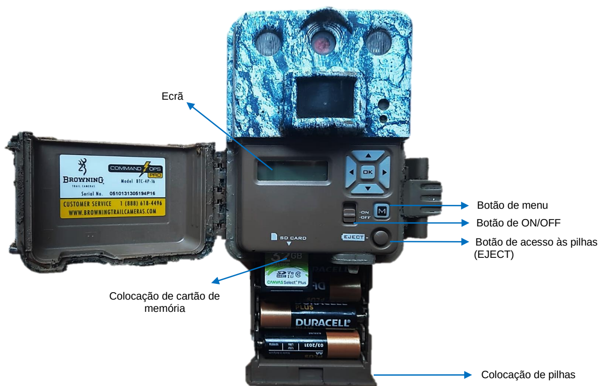
Figura A.2 | Especificações no interior das câmaras de vídeo utilizadas nos trabalhos da Sub-Ação C8.2, incluindo painel de controlo, local de cartão de memória e acesso a pilhas (modelo: Command Ops Pro, BTC-4P-16, Browning). © Beatriz Martins
