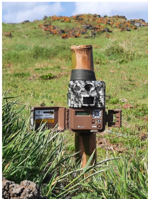
Figura A.3 | Exemplo de câmara de vídeo colocada no Ilhéu da Praia (2021), com o auxílio de cana de bambu e braçadeiras. © Beatriz Martins
