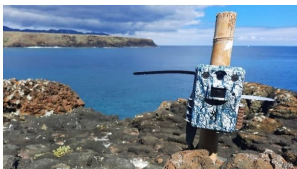
Figura 1 | Câmara de vídeo trapping com sensor de movimento colocada no Ilhéu da Vila (modelo Browning Command Ops Pro). © Beatriz Martins
