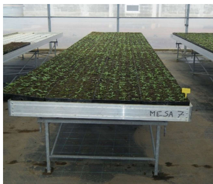
Figura 4. – Bancadas em alumínio e aço galvanizado.
