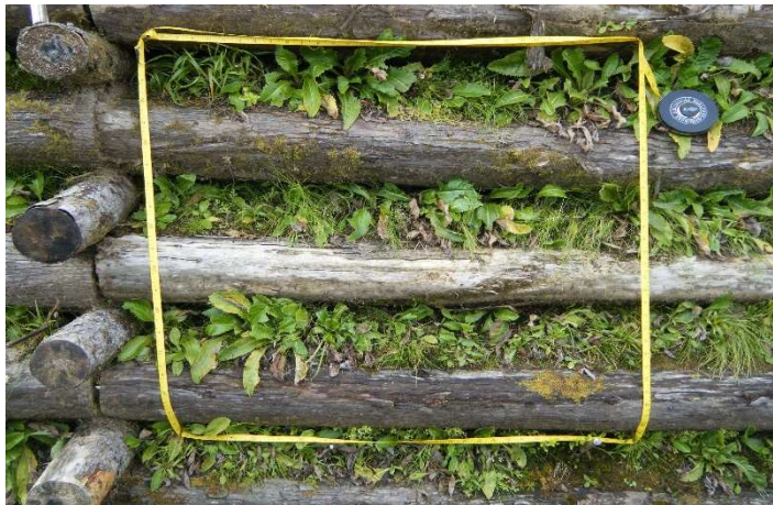
Figura 15 – Monitorização de parcelas de vegetação 1m x 1m das técnicas de hidrosementeira.
